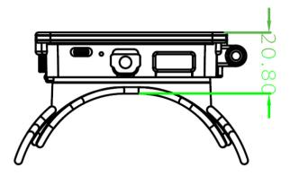
**Diemension :** L128.05mm×W79.2mm×H20.8mm **Weight :** 275g
