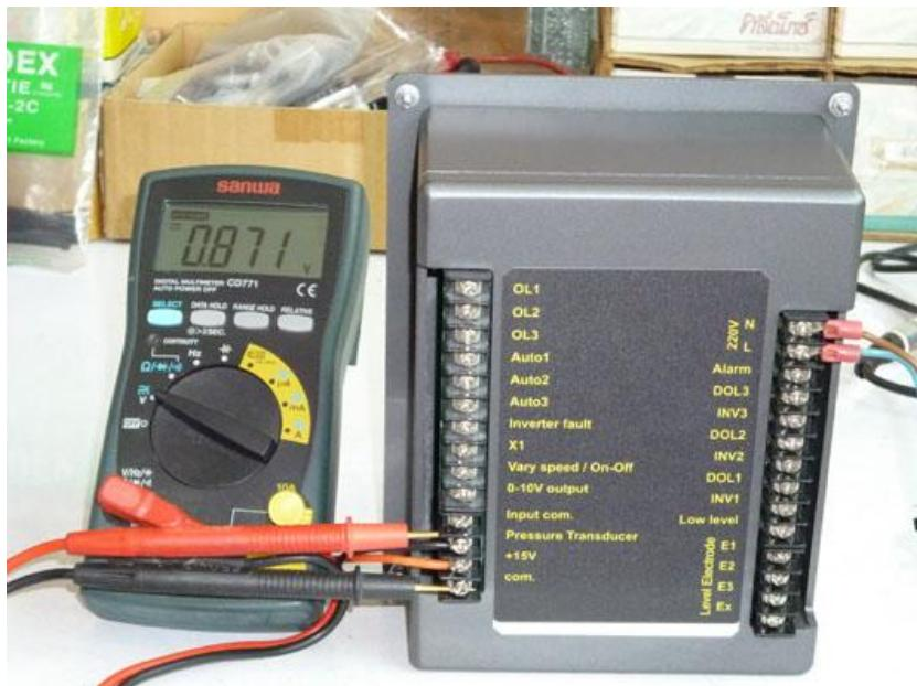
ใช้ DC voltmeter วัดแรงดันระหว่างข้า pressure transducer และ com. ที่สเกล 0-10 bar ให้ผลดังนี้
