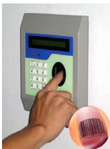
Sm@rtClock M04F เป็นเครื่องรุ่นแรกๆ ของโลก (จำหน่ายระหว่างปี 2002- 2007) ที่ออกแบบโดยใช้ Optical Sensor ที่เป็นกระจก Crystal ทนรอยขีดข่วน
